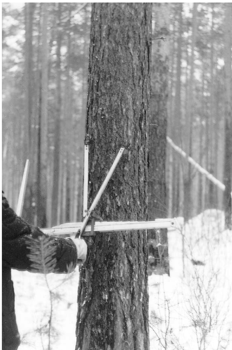
Рис. 27. Разметка карр вилкой-разметчиком КарНИИЛП
